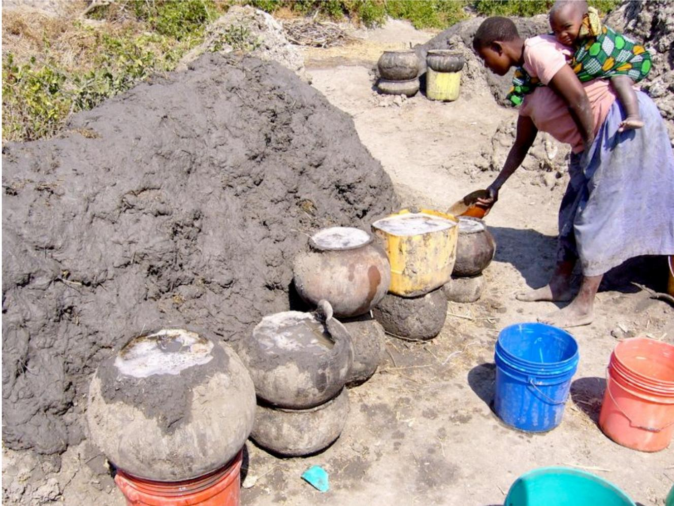
Salzproduktion um Dodoma. Die salzige Erde wird mit Wasser aufgelöst und durch einen Hirseschrotfilter abgelassen. Dann wird die Lake auf dem offenen Feuer gekocht, bis das Salz allein zurückbleibt. Hier arbeiten nur Frauen. Den ganzen Tag unter der sengenden Sonne Tansanias.
